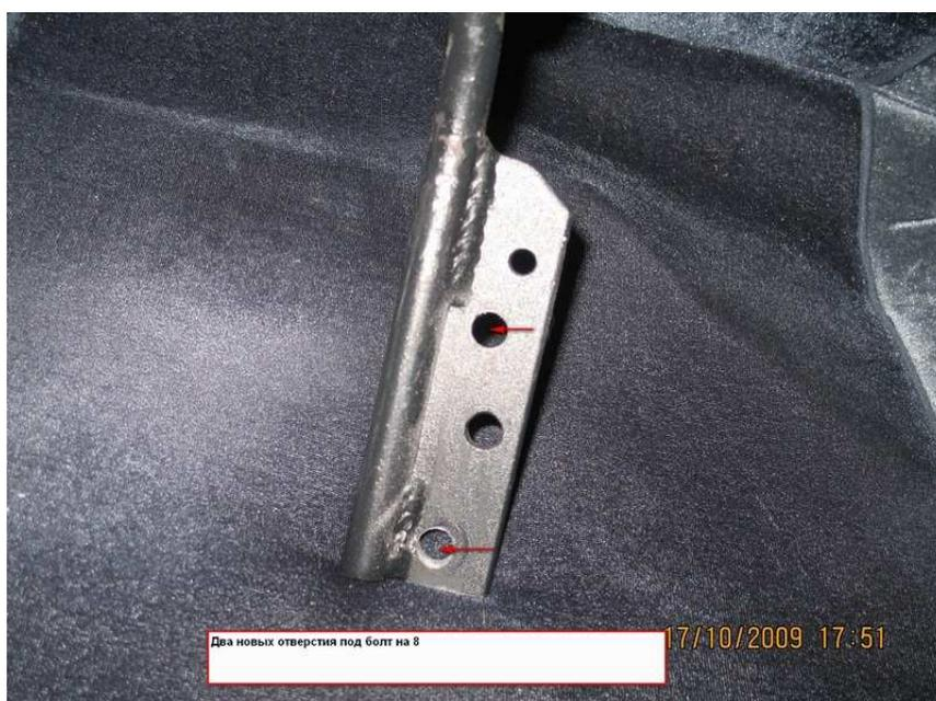
Два новых отверстия под болт на 8
