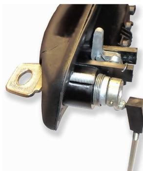
Если вы используете механические замки, То после демонтажа водительской ручки **не вынимая ключа из личинки замка!** Извлеките саму личинку и установите в новую ручку. Для этого вам необходимо вставив личинку (1) в алюминиевое кольцо ручки. Одеть пружину (2) таким образом, чтобы усики пружины цеплялись одной стороной за паз личинки, второй за прорезь в алюминиевом кольце ручки. При правильной установке, личинка будет самостоятельно возвращаться в исходное
